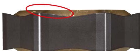
Pochylona krawędź skrawająca i duży kąt natarcia
